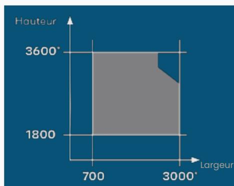
LES DIMENSIONS MAXIMALES VARIENT EN FONCTION DE PLUSIEURS FACTEURS, NOTAMMENT LES EXIGENCES DE RÉSISTANCE AU VENT ET D'ÉTANCHÉITÉ À L'EAU.
